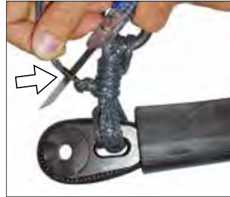
Step 4: taglio cima in eccesso cut exceeding line
